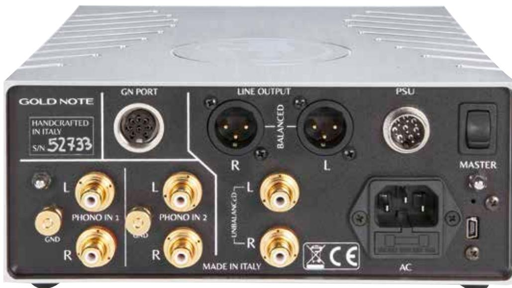
◀ Die Rückseite zeigt fest mit dem Gehäuse verschraubte und vergoldete Cinch-Ein- und -Ausgänge. Zusätzlich steht ein XLR-Ausgang bereit, der, wie es bei echten symmetrischen Outputs üblich ist, den Pegel um sechs Dezibel anhebt. Die Micro-USB-Schnittstelle dient etwaigen künftigen Updates und die weiteren Buchsen sind Zusatzoptionen.
