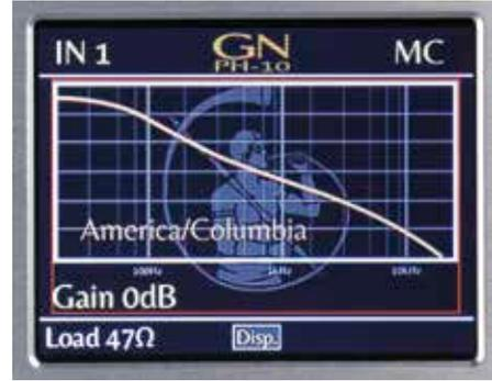
MMs. In einem kleinen Fenster unten links erscheint der eingestellte Widerstand, und er stimmt auffallend genau. Rund acht Ohm betrug während eines Labor-Checks die Abweichung, was für die Praxis bedeutungslos ist.
